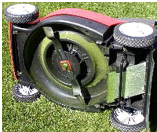
Figura 7. Máquina cortadora de pasto. En su base tiene cuchillas que en su rotación seccionan el pasto, y eventualmente proyectan materiales potencialmente contundentes que se encuentran en el suelo.
